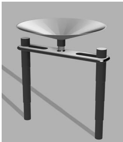
Figura 12 – Detalhe da braçadeira e dos parafusos de encaixe do prato nos tubos de fixação
